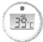
La température de l'eau est trop chaude, le thermomètre affiche «HOT» et le témoin lumineux s'allume en rouge : ajouter de l'eau froide et brasser l'eau jusqu'à ce que la température redescende à 37°C.
